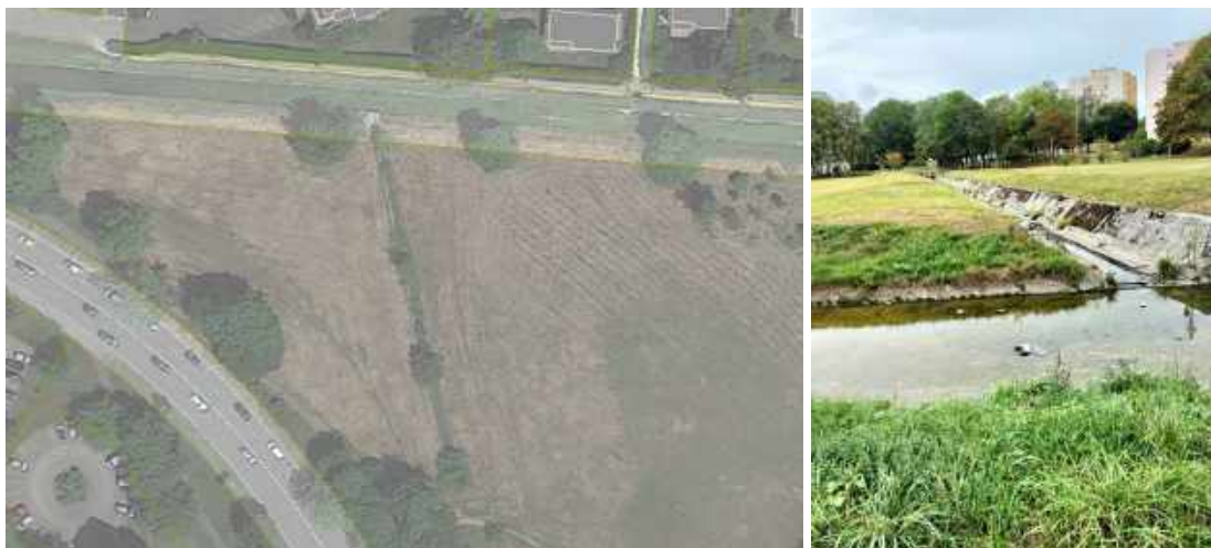
Figure 52 : pluvial démolit et remplacé par une noue dans le parc Colette Besson
